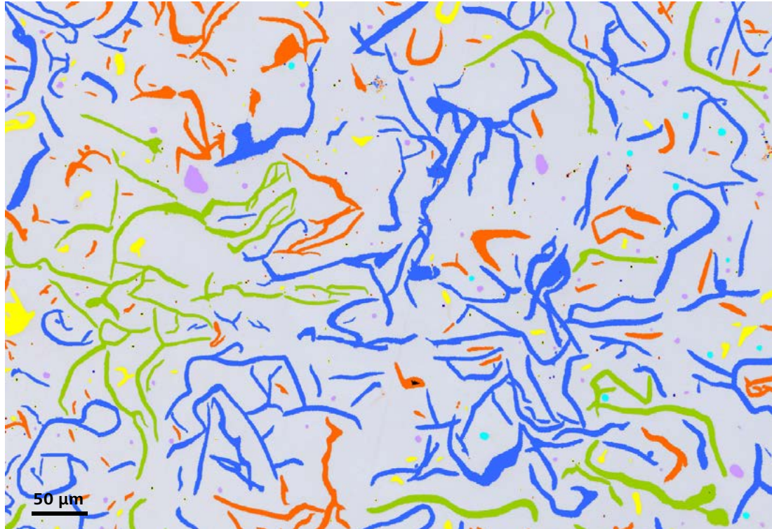
ZEISS ZEN 2 core ile döküm demir analizi
