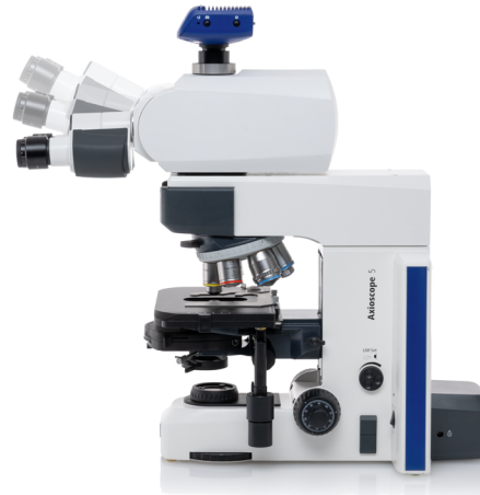
25 mm görüntü alanı ve -2 ile +28° arası eğme açılı ergonomik, kamera adaptörlü başlık. Ortak gözlem kurulumları için de uygundur.
